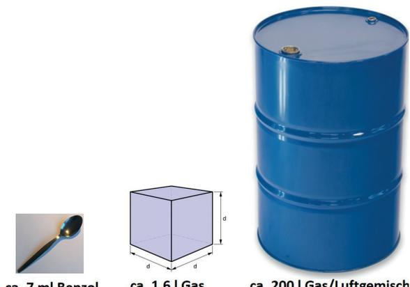
Abb. 3: Verdeutlichung des Verhältnisses Flüssigkeit zum Gas-Luft-Gemisch (d: ca. 11,5 cm, Bsp. Benzol)
